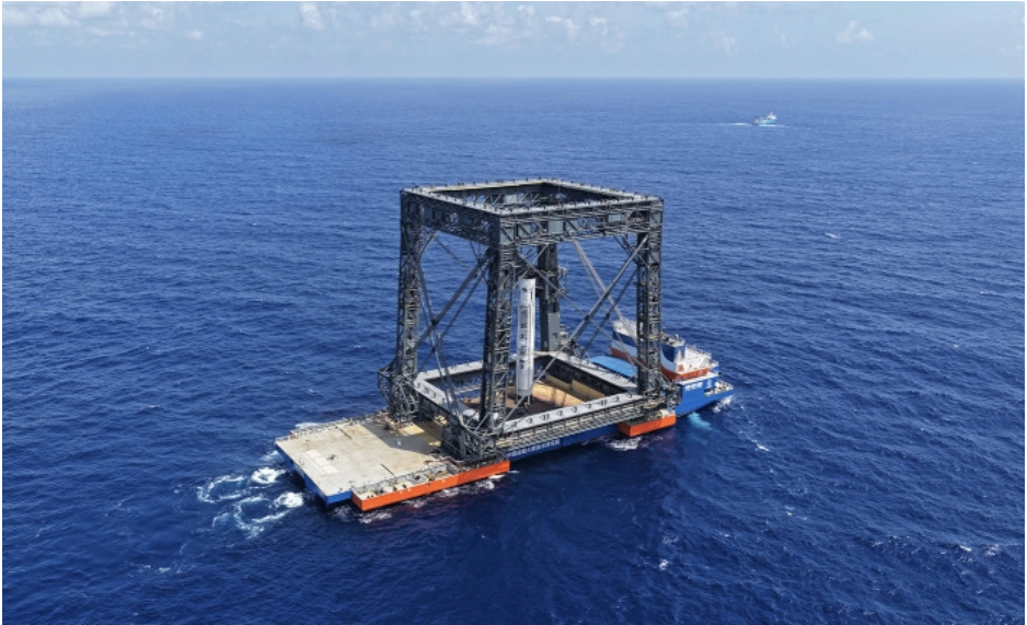
图为海上回收平台通过网系捕获方式成功回收长征十号乙运载火箭一子级。
