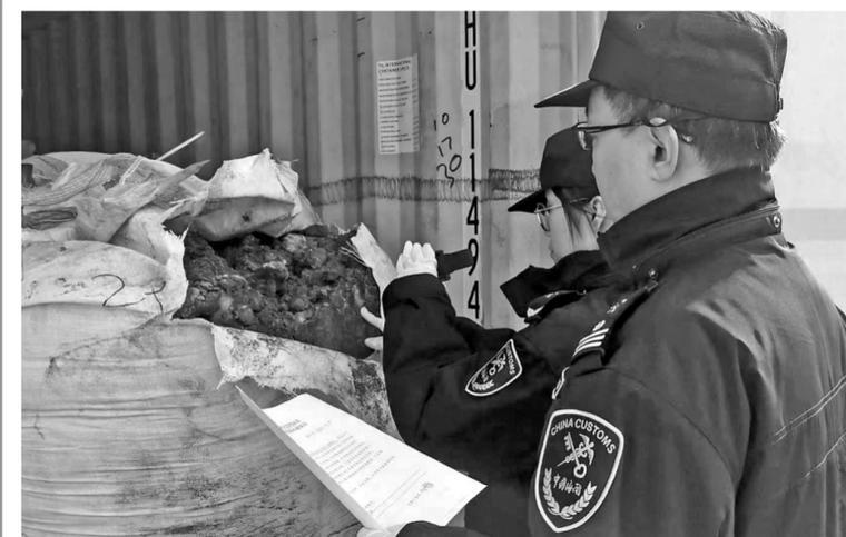
近日，在大连海关所属大窑湾海关现场监管下，528.4吨洋垃圾在大窑湾港码头装船运往出境。大窑湾海关关员在现场查验时发现，该批申报品名为“银矿”的货物，实际为深灰色粉末及块状固体，潮湿结块，粒度不均，理化特性与银矿特征不符。经鉴定，该批货物为湿法炼锌产生的铅银酸浸渣，属于国家禁止进口的洋垃圾。大窑湾海关第一时间协调港务、船公司等相关单位推进退运处置工作，全程监管确保此批洋垃圾全部退运出境。图为海关关员查验现场。
