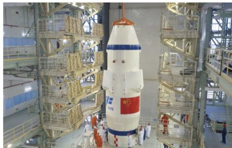
图为神舟十五号载人飞船船艙组合体吊装。
