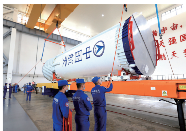
图为技术人员开展火箭吊装。
